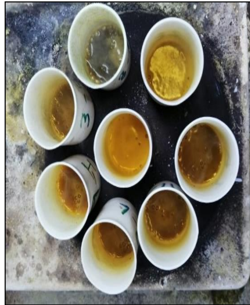
الشكل (٨): في أثناء العمل المختبري، هضم العينات، ومن ثم قياس التركيز في جهاز المطياف الذري.
